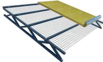
2. Presentar la lana de vidrio por encima de la malla y desenrollar desde el punto más alto en el sentido de la pendiente, con el foil de aluminio hacia abajo (barrera de vapor) desdoleando la solapa.
