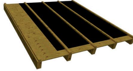
2. Colocar los listones yeseros (2"x1") sobre el aislante hidrófugo (paso 1) fijándolos con clavos, previamente alineados a cada uno de los cabios.
