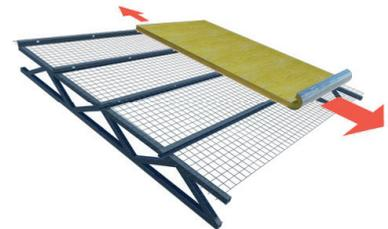
3. Traccionar la malla y la lana en forma conjunta, permitiendo que la lana recupere su espesor entre correas.
