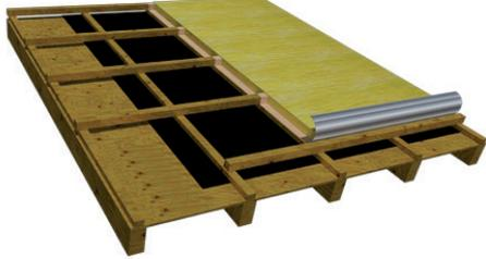
4. Desenrollar desde lo más alto del techo el Rolac Plata Cubierta hacia abajo, en el sentido de la pendiente pasando por encima de clavaderas (paso 3). Al finalizar corte la lana de vidrio con un cúter. (tramo 1).
