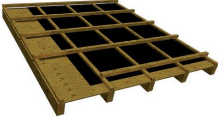
3. Ubicar las clavaderas (2"x1") de forma perpendicular a los listones yeseros a una distancia mínima de 50 cm y una máxima de 70 cm. Fijándolas con clavos de acero (4/5") cada 40 cm.
