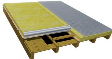
6. Presentar una chapa clavándola encima del rollo de lana de vidrio tramo 1, dejando expuesta solo el tramo 2 para continuar con el proceso (pasos 4-5-6). Colocar las chapas a medida que se avanza con la aislación, para no dejar la lana de vidrio expuesta. Tener en cuenta las zinguerías y terminaciones correspondientes.
