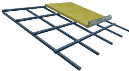
1. Presentar la lana de vidrio por encima de la estructura\* en el sentido de la pendiente, con el foil de aluminio hacia abajo (barrera de vapor) desplegando la solapa. \*Estructura de pequeñas luces.
