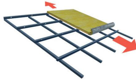
2. Traccionar con cuidado el Rolac Plata cubierta permitiendo que la lana recupere su espesor entre correas.
