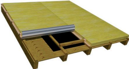
5. Coloque el siguiente rollo de lana de vidrio, sobre lo más alto del techo, desenrollándolo hacia lo más bajo y con la solapa orientada hacia el mismo lado. Unir ambos rollos mediante la solapa y la cinta autoadhesiva logrando una unión sellada.
