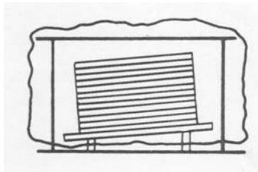
b) Almacenar los paquetes y bobinas separados del piso, con una pendiente, de modo que si la lluvia penetrara la cubierta, el agua pueda drenar hacia afuera.
