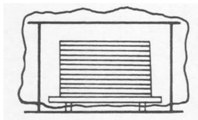
a) Colocar una estructura ó armazón de apoyo, alrededor de los paquetes ó bobinas, cubriéndolos luego con plástico ó con una lona impermeable. Dejar espacio entre la cubierta y las chapas para permitir la circulación de aire.
